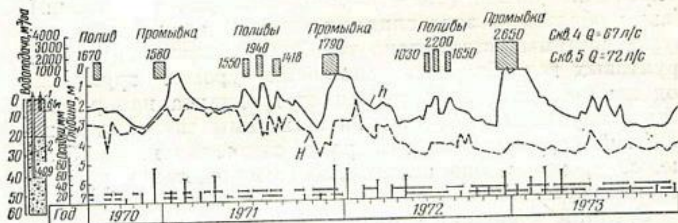
Рис. 23. График режима грунтовых и напорных вод на орошаемом поле, куст № 60 (хлопчатник), на фоне вертикального дренажа. Совхоз «Социализм», Шурузьякский массив:
