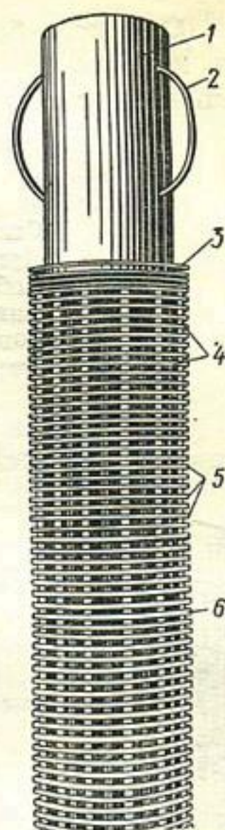
Рис. 45. Конструкция каркасно-стержневого фильтра (Дрогобычский завод):
