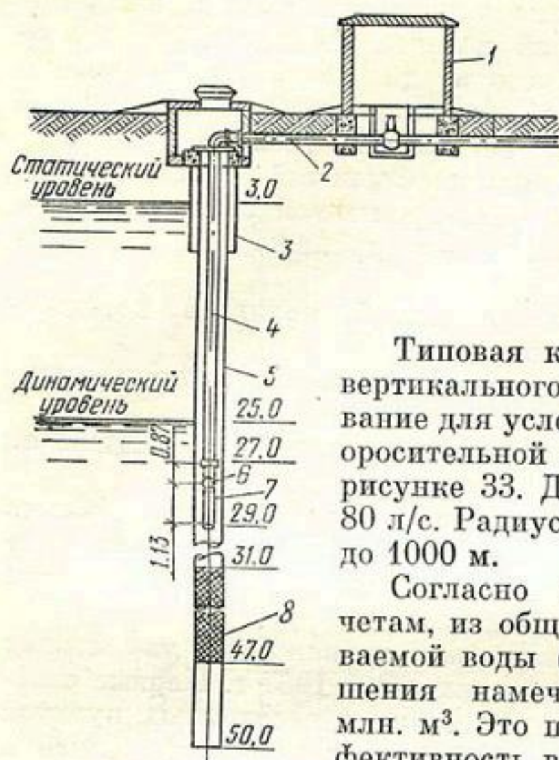
Рис. 33. Типовая конструкция скважины вертикального дренажа:
