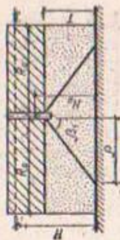
11. Наклонные скважины в пласте круговой формы (в плане)
