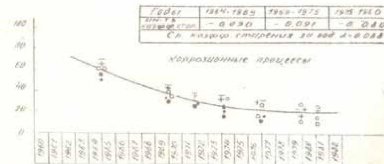
Рис. 3. Изменение дебита скважины в процессе физико-химической коагуляции в зависимости от продолжительности их работы
