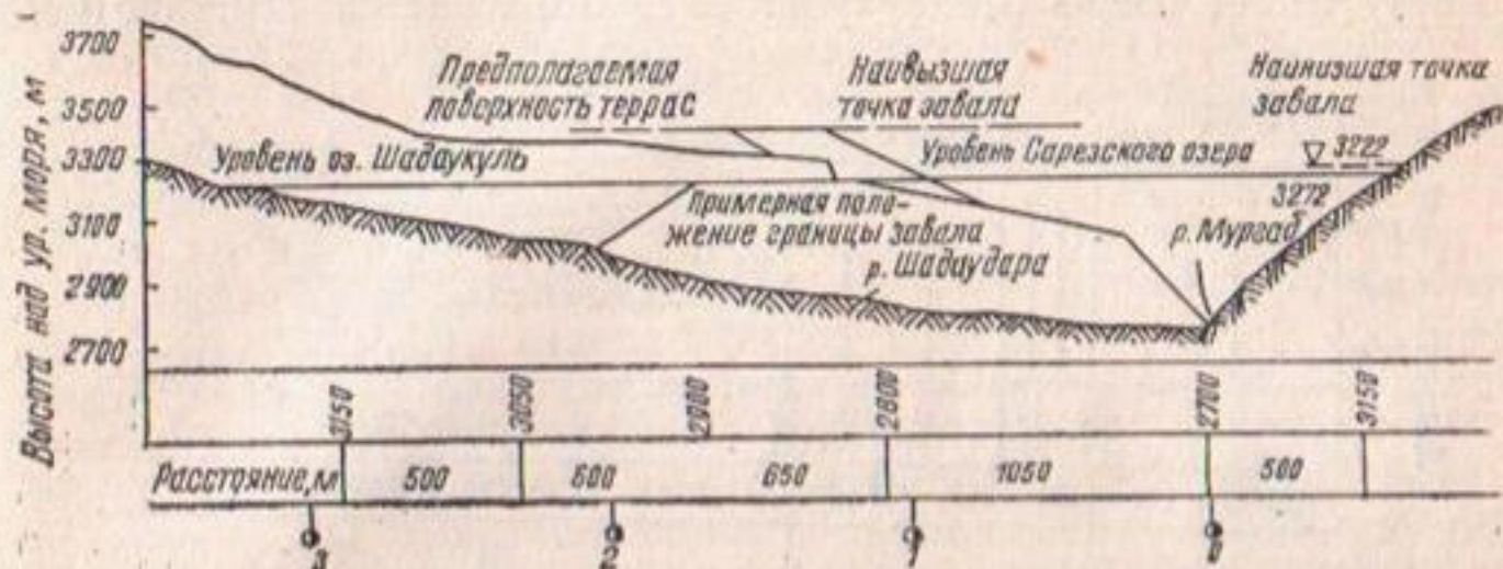
Рис. 3. Совмещенные поперечные профили на левом берегу. Значительная масса обвала легла на конус выноса р. Шадаудара впереди террас.
