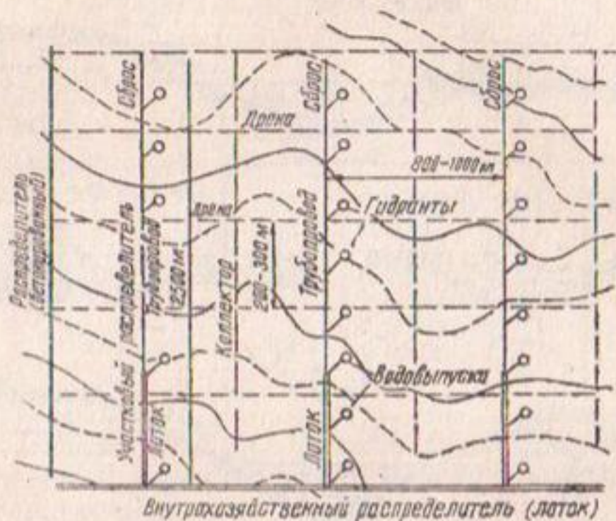
Рис. 3. Типовой участок с лотковыми и закрытыми распределителями.
