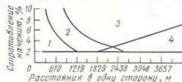
Рис. 54. Зоны эффективных условий работы самоходных скреперов и землевозов: 1, 2 — скреперы соответственно с фронтальной загрузкой ковша и с толкачом; 3, 4 — автомобили-землевозы с задней и донной разгрузкой.
