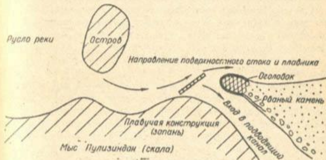
Рис. 17. Схема реконструированного бесплотинного водозабора в ЮМК.
