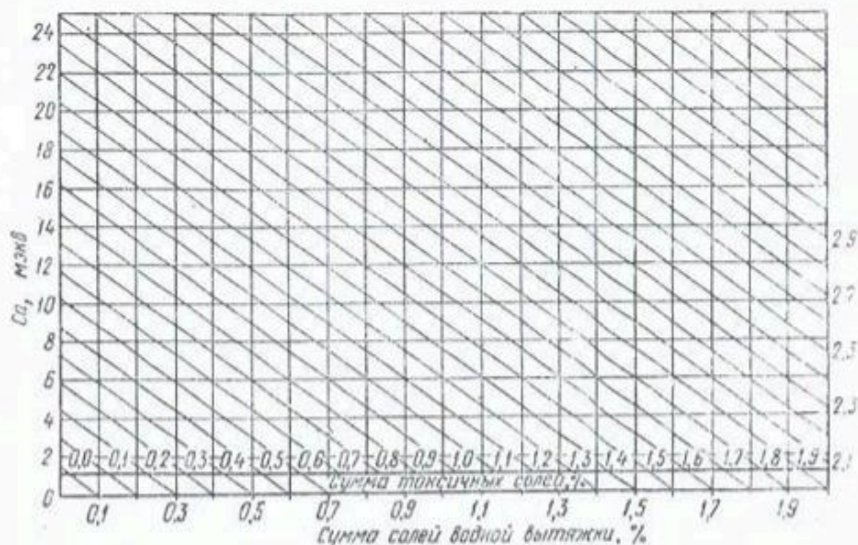
Рис. 11. Номограмма для расчета суммы токсичных солей по водным вытяжкам.
