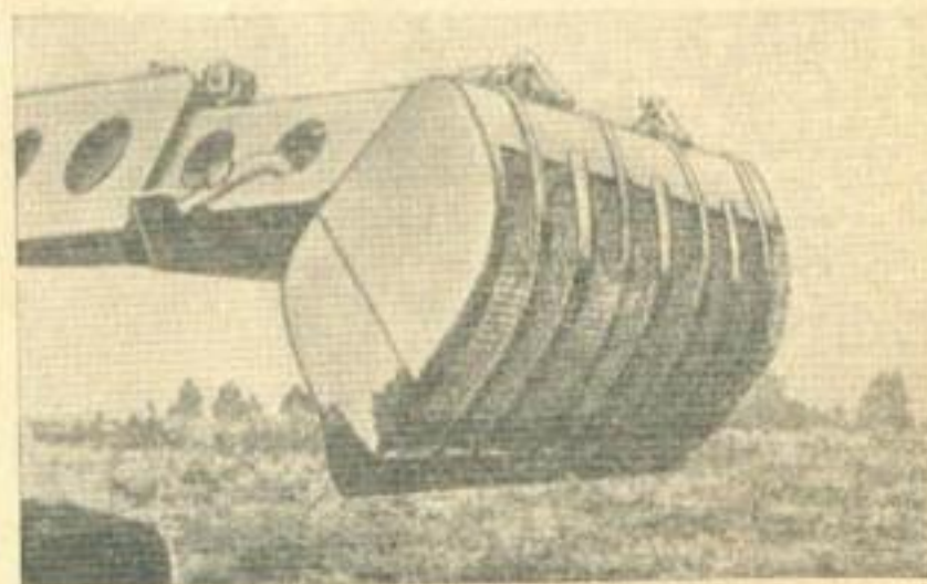
Рис. 5. Специальный ковш для работы в водонасыщенных грунтах.
