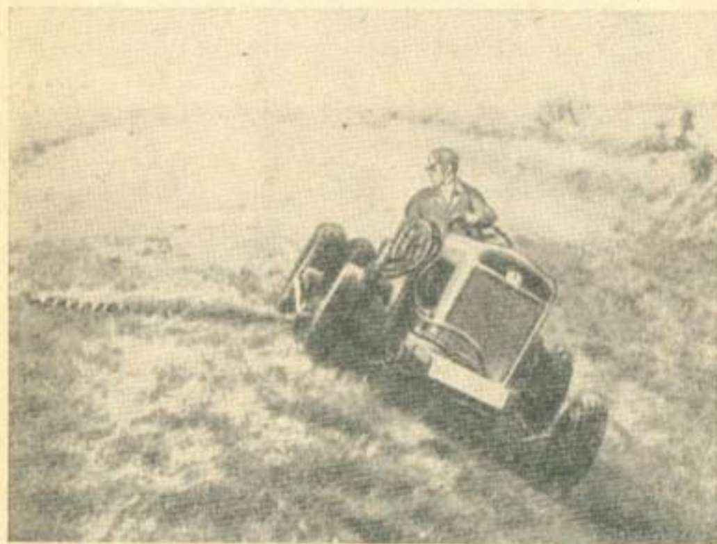
Рис. 22. Трактор Якобзен для окашивания откосов (ФРГ).
