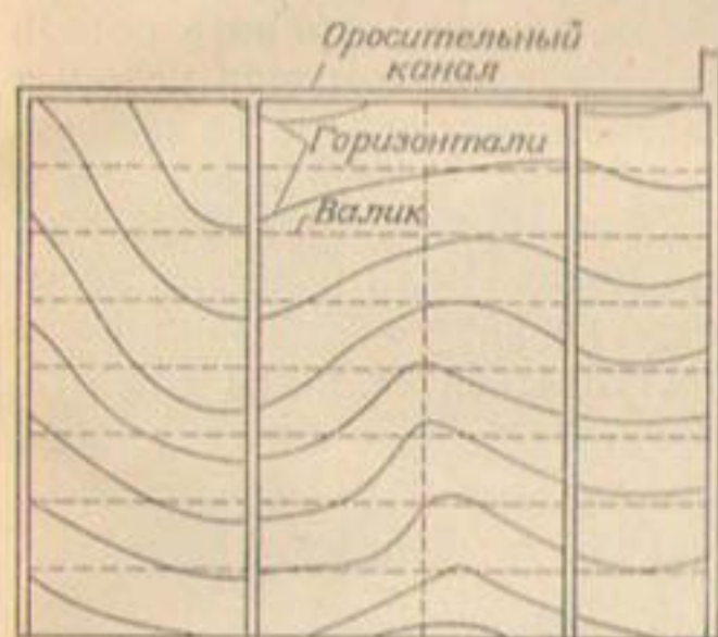
Рис. 74А. Разбивка орошаемого участка на чеки.
