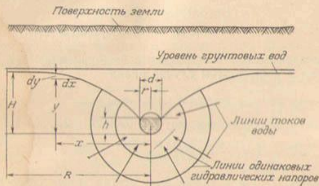
Рис. 151. Схема радиальных токов грунтовых вод в направлении к дренам, прорытым в однородной почве. Уровень грунтовых вод расположен на (H - h) м выше горизонта воды в дренах.
