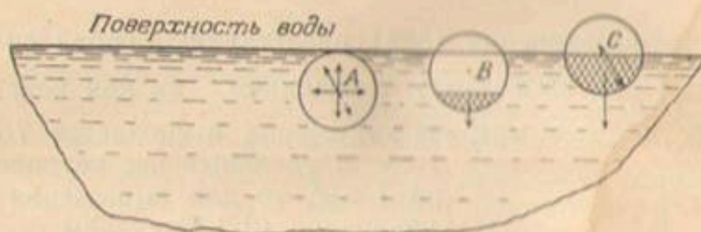
Рис. 103. Схема поверхностного натяжения, возникающего под действием неуравновешенных молекулярных сил.
