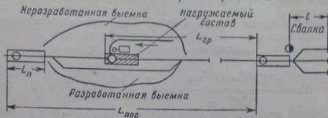
Рис. 121. Схема железнодорожной отвозки грунта при экскаваторных работах.
