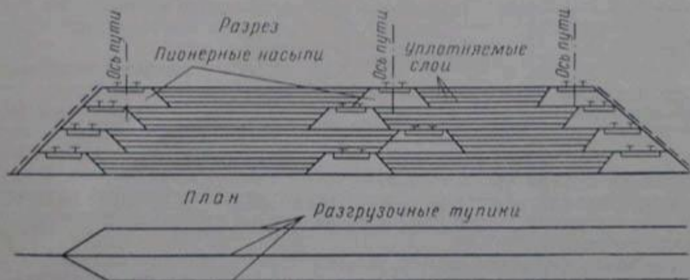
Рис. 118. Тупиковая схема подачи грунта на плотину железнодорожным транспортом.
