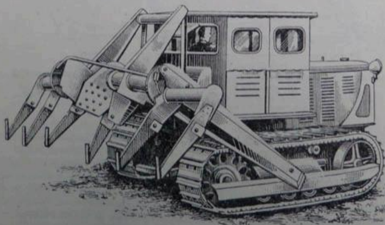
Рис. 231. Навесной многолинейный кротователь.
