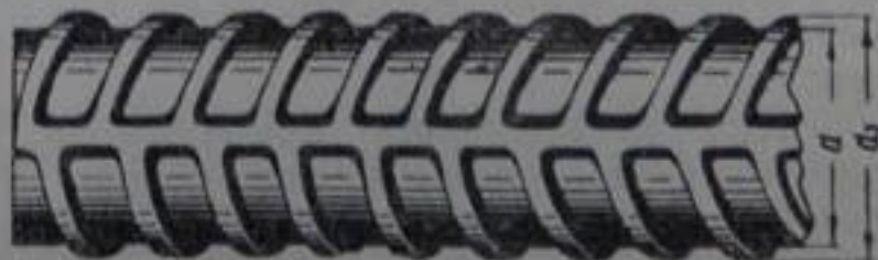
Рис. 286. Горячекатаная арматурная сталь периодического профиля.
