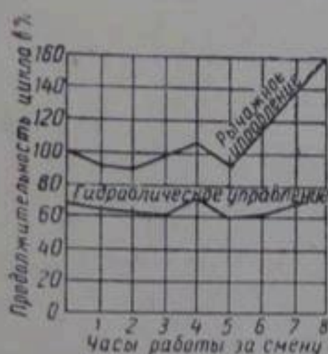
Рис. 89. Влияние типа управления экскаватором на время цикла в различные часы рабочей смены.
