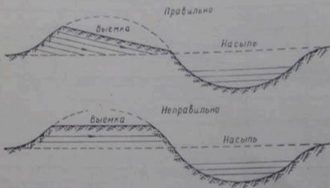
Рис. 38. Набор грунта скрепером при продольной возке.
