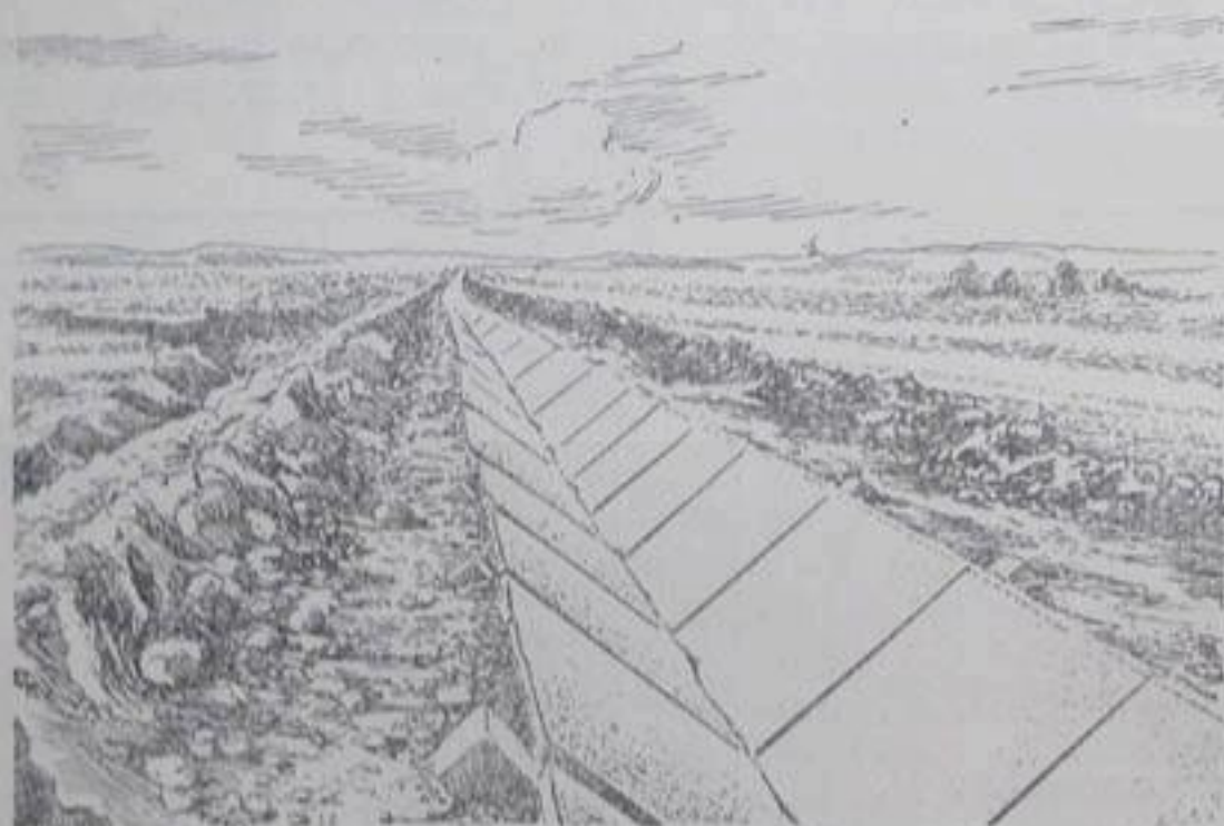
Рис. 322. Облицовка канала треугольного сечения сборными железобетонными плитами.
