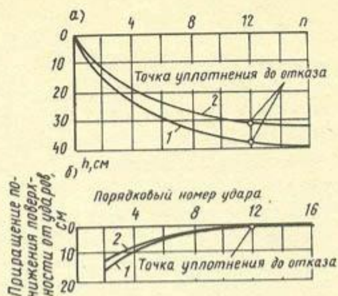
Рис. 1. Понижение трамбуемой поверхности h в зависимости от числа ударов n (а) и от каждых двух ударов (б) 1 — в суглинке; 2 — в супеси
