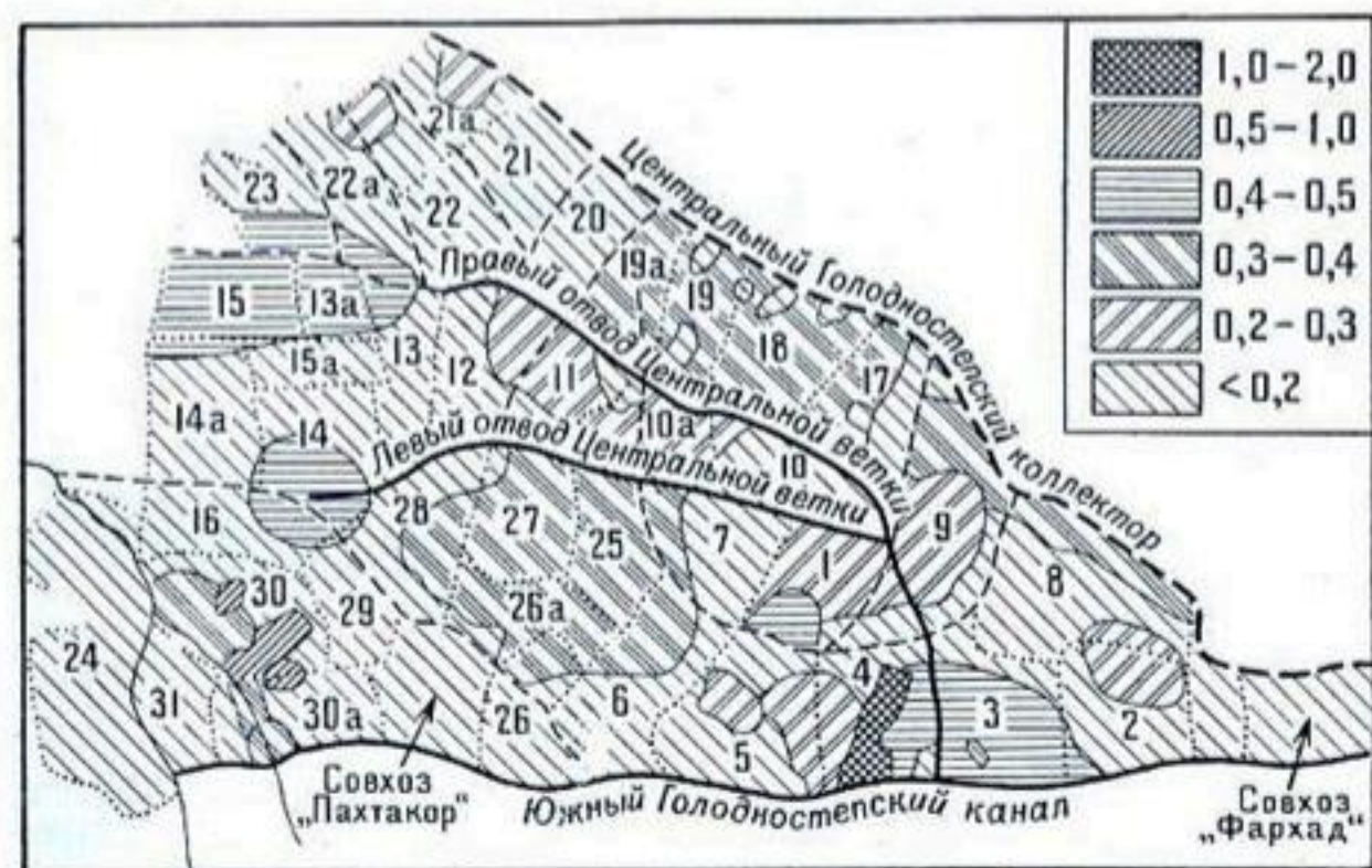
Рис. 4. Схема распределения площадей Голодной степи по коэффициентам фильтрации активной толщи, м/сут.
