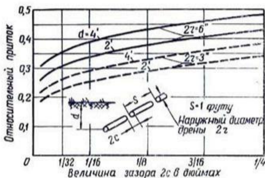
Рис. 139. Зависимость между относительным притоком в дрена и величиной зазоров. По теоретическим расчетам Киркхема (1950).
