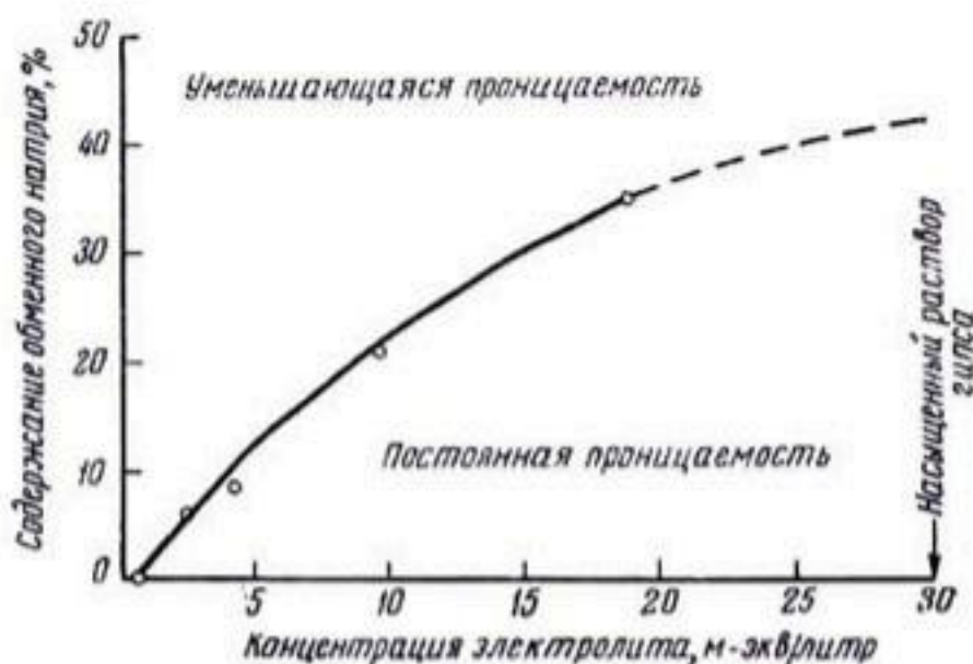
Рис. 178. Концентрация электролитов в пригационной воде, требующаяся для сохранения постоянной почвенной проницаемости при различной степени насыщения обменным натрием. По Квирку и Скофилду (1955).
