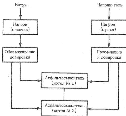
Рис. 5-3. Схема передвижного асфальто-битумного цеха
