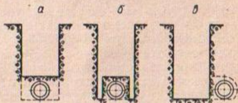
Рис. 83. Способы рытья траншей для перекладки дрен:
