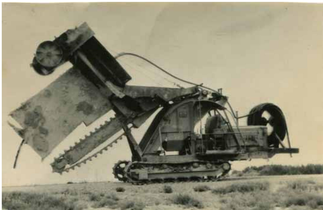
Рис.1.26. Экспериментальный дренаукладчик ДЩ-251 в транспортном положении
