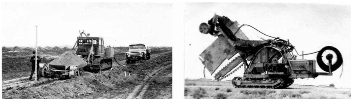
Рис. 5.12. Дреноукладчик ЭДШ – 251 в рабочем (а) и в транспортном положении (б)
