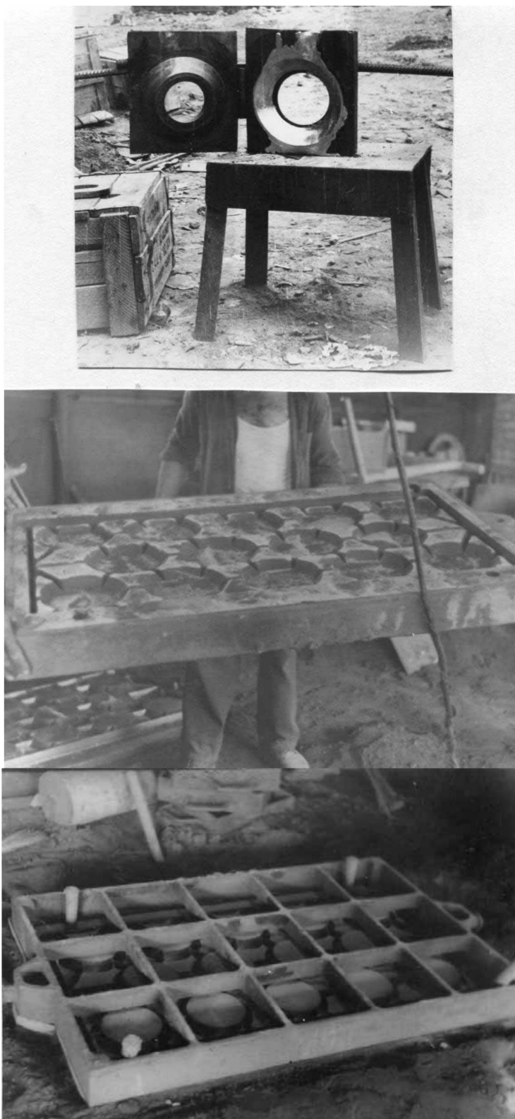
Рис. 3.9. Изготовление оснастки для отливки профильных поддонов на Янгйерском заводе
