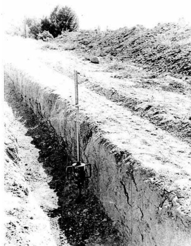
Рис. 4.30. Пенетромтр ДИИТ–4 погруженный в уплотненный грунт
