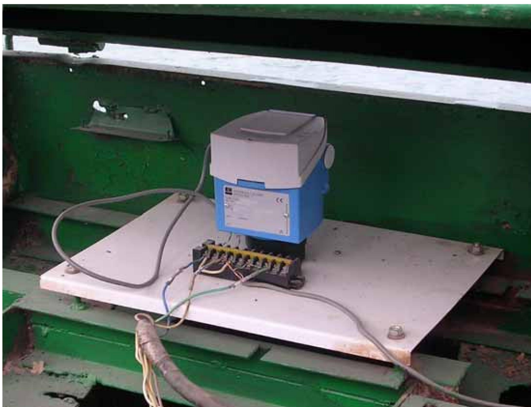
Рис. 1. Датчик уровня воды
