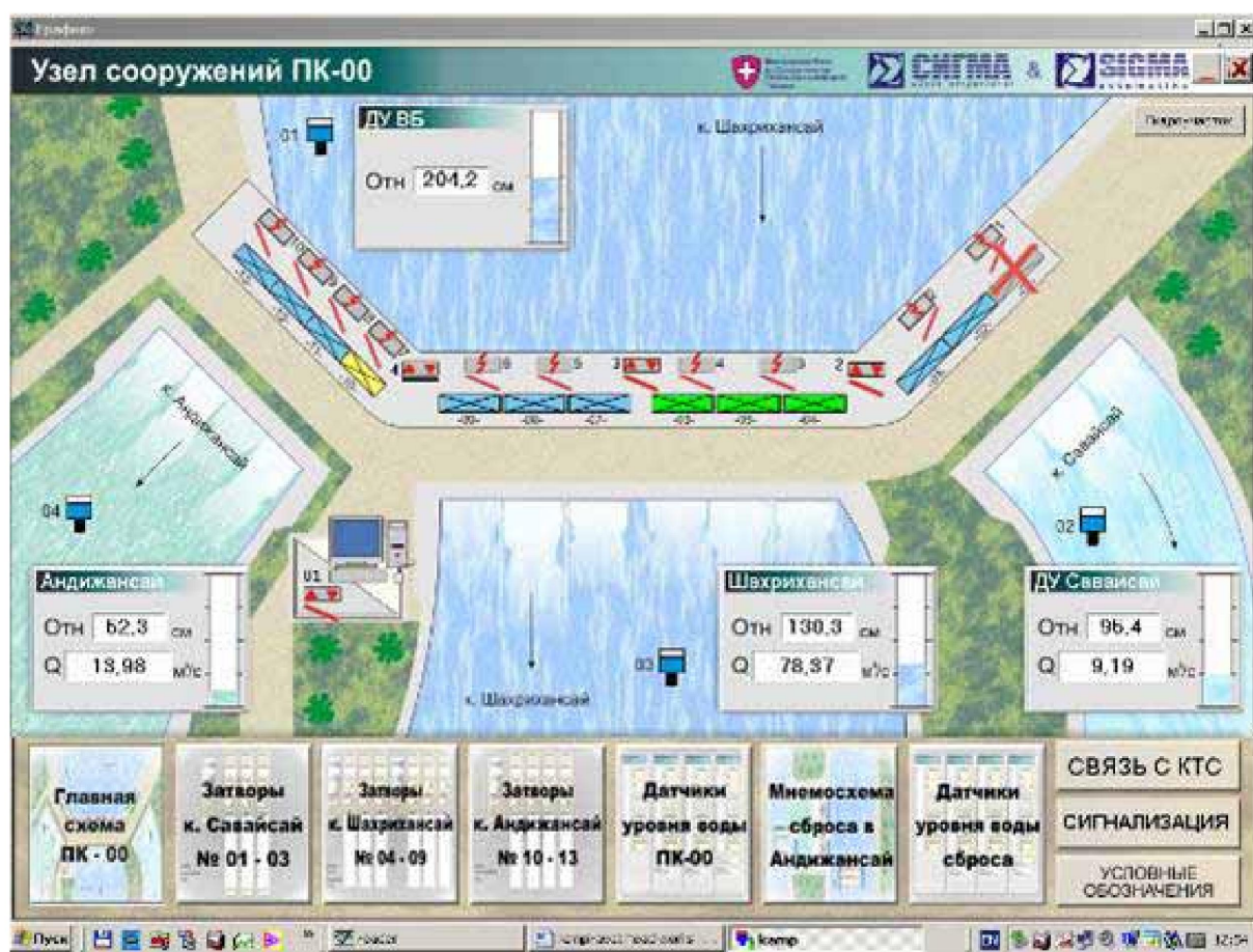
Рис. 12. Кампирраватский гидроузел главная мнемосхема системы SCADA
