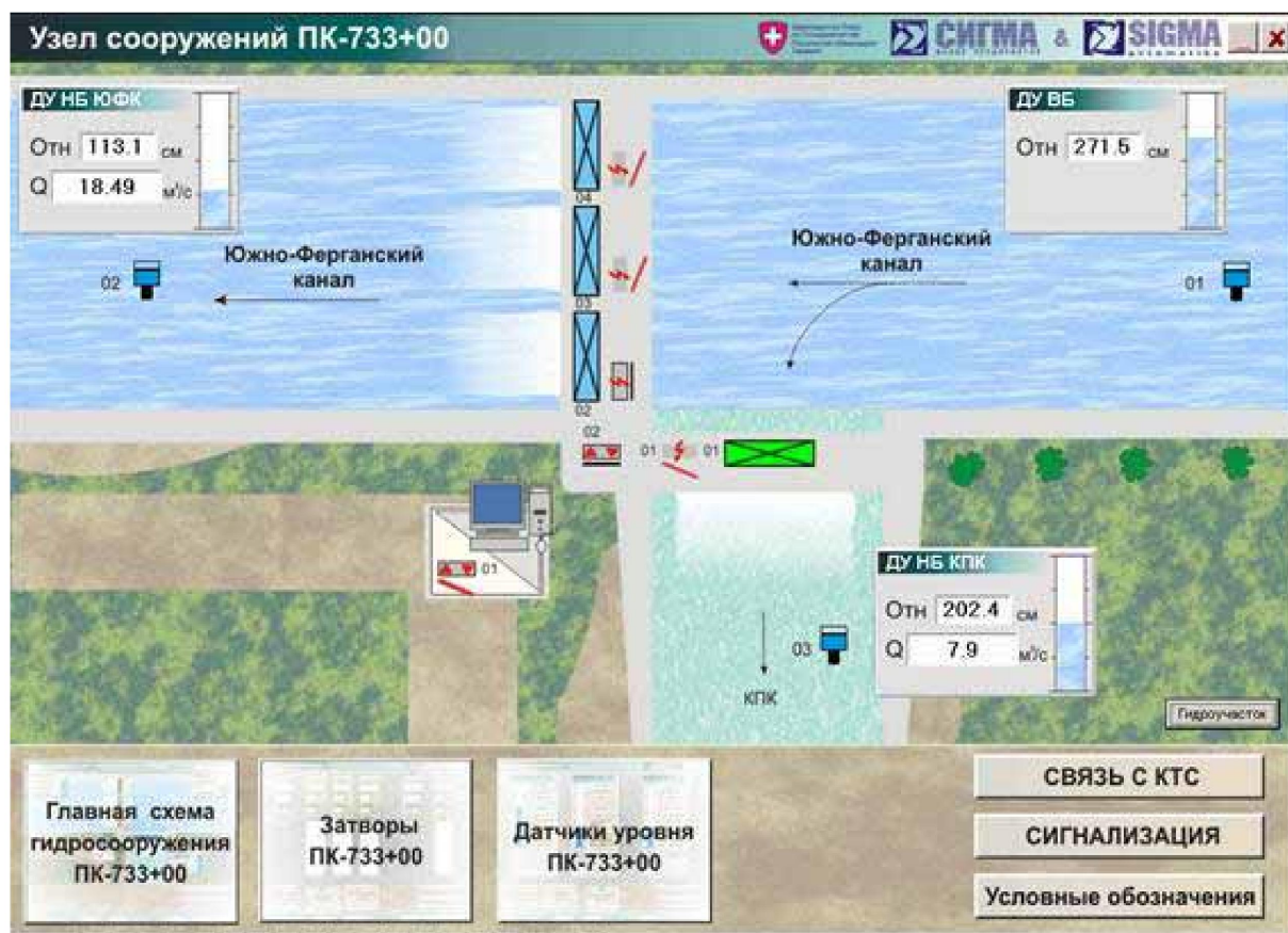
Рис. 14. Сооружение Хамза, главная мнемосхема системы SCADA
