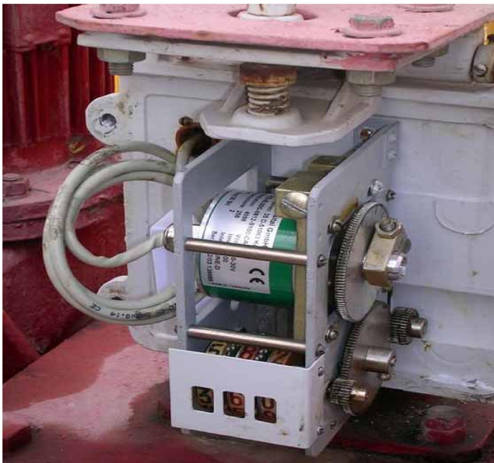
Рис. 3. Датчик положения затвора (ДПЗ)
