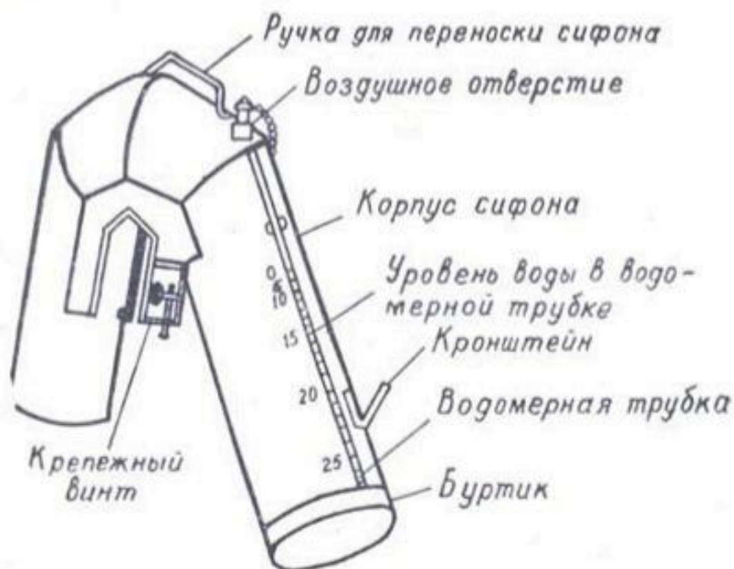
Рис. 13. Металлический сифон для забора воды из лотковых каналов.
