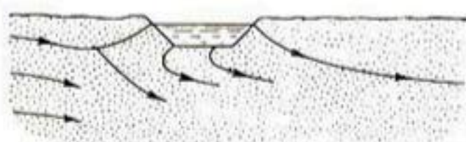
Рис. 8-36. Схема подпертой фильтрации из канала.
