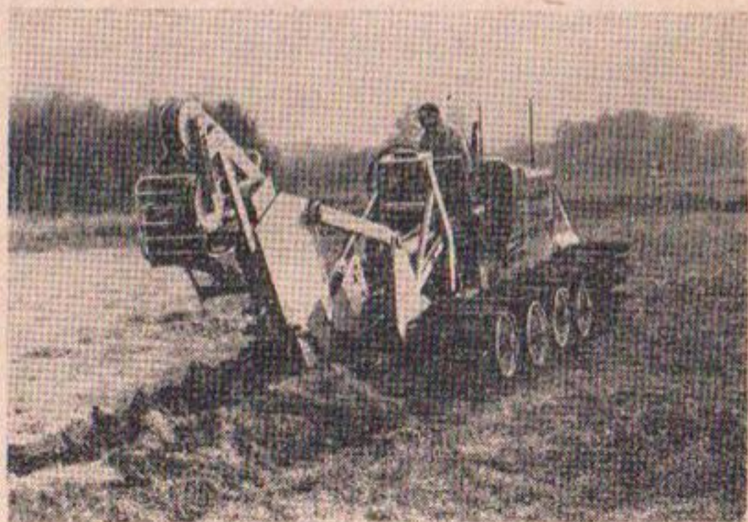
Рис. 38. Австрийский дреноукладчик «Дреномат-90».
