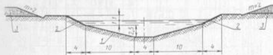
Рис. 5. Поперечный профиль канала Днепр — Кривой Рог: 1 — суглинок; 2 — отсыпка щебня диаметром 4—7 см и слоем толщиной 20 см; 3 — кавальер. (Размеры в м).
