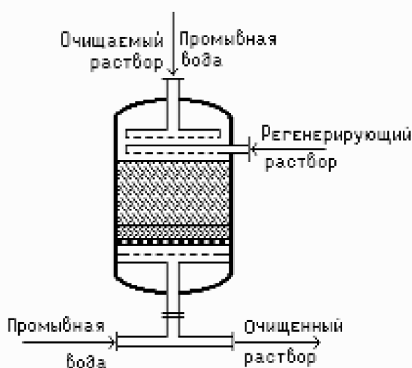
Рис. 10.1. Ионообменный аппарат с неподвижным слоем ионита
