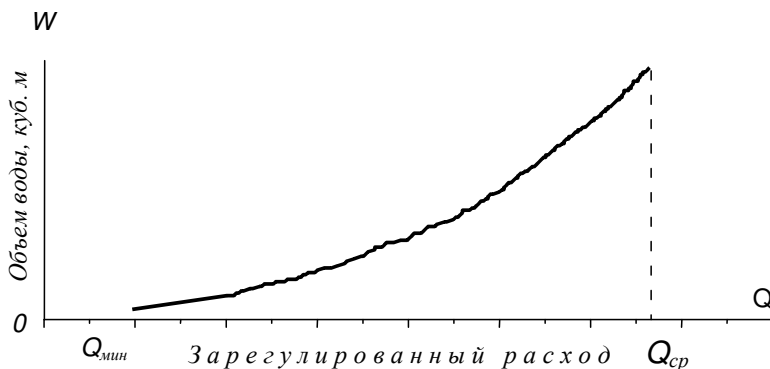
Рис. 16. Зависимость зарегулированного расхода от объема водохранилища
