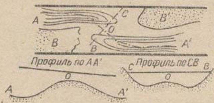
● Рис. 150. План сдвинутого переката и его продольные и поперечные профили.
