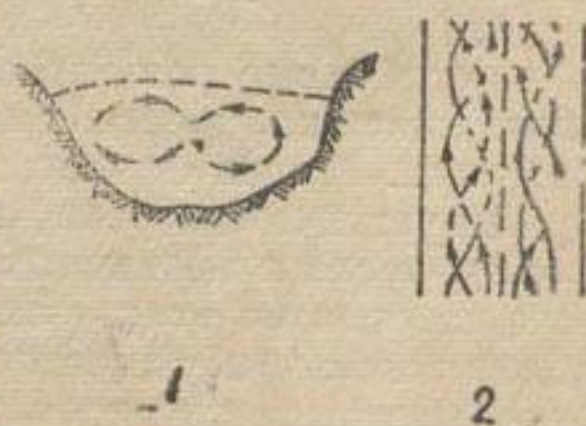
Рис. 170. Схема поперечной циркуляции (по Н. С. Лелявскому):
