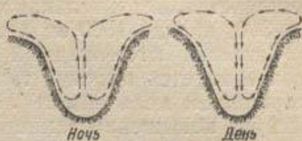
Рис. 66. Схема горно-долинных ветров (склонов).
