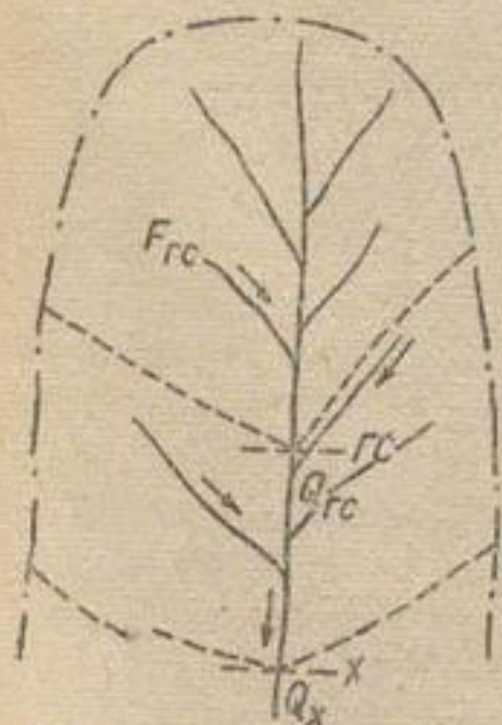
● Рис. 106. Схема к переносу характеристик стока из гидрометрического створа г.с. в рассматриваемый проектный створ х.
