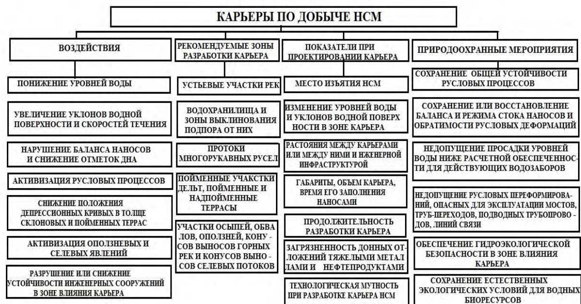
Рисунок 2 – Схема организации карьеров добычи НСМ
