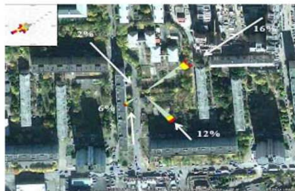
Рис. 4. Восстановленное суммарное поле выпадений пыли в снеге от ТЭЦ-2 и ТЭЦ-3 Новосибирска ( \text{г}/\text{м}^2 ) (а); измеренная и вычисленная концентрации пыли в точках отбора проб (б); восстановленная концентрация пыли в северо-восточном направлении от ТЭЦ (в); обозначения: \circ – опорные точки, \bullet – контрольные точки наблюдений, * – положение источников
