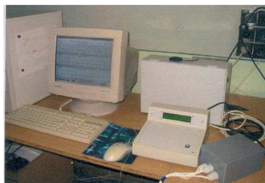
Рис. 2. Сейсмическая станция CPC-KM/V-F.
