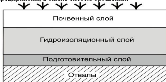
Рис. 11. Физический барьер, создаваемый на поверхности отвалов.
