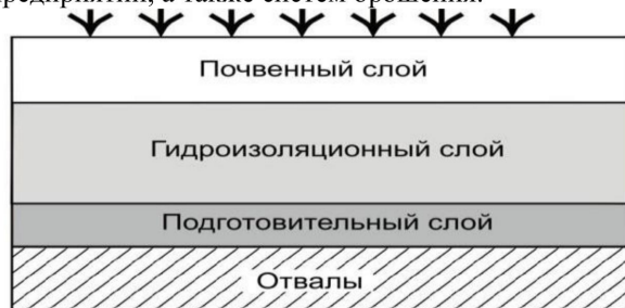
Рис. 11. Физический барьер, создаваемый на поверхности отвалов.
