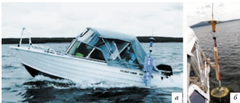
Рис. 2. Маломерное исследовательское судно, оборудованное для выполнения промерных работ, акустического профилирования и отбора проб донных отложений (а); набортное использование профилографа с приемником GPS-ГЛОНАСС (б).
