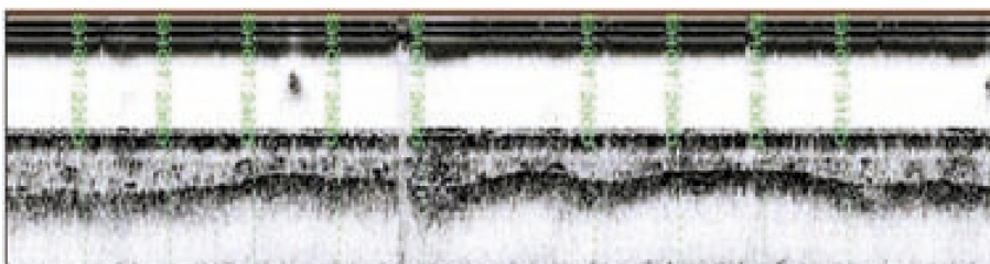
Рис. 3. Пример профилограммы донных отложений, длина профиля порядка 800 м (хорошо видно слоистое строение осадочной толщи донных отложений в озерной части водохранилища).
