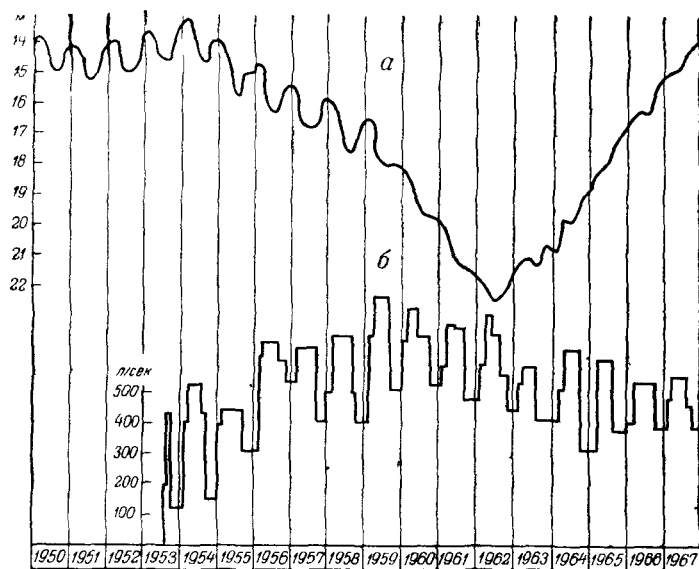
Рис. 48. Сводный график изменения уровня (а) и дебита (б) эксплуатационной скважины по среднемесячным данным в районе Ашхабадского водозабора
