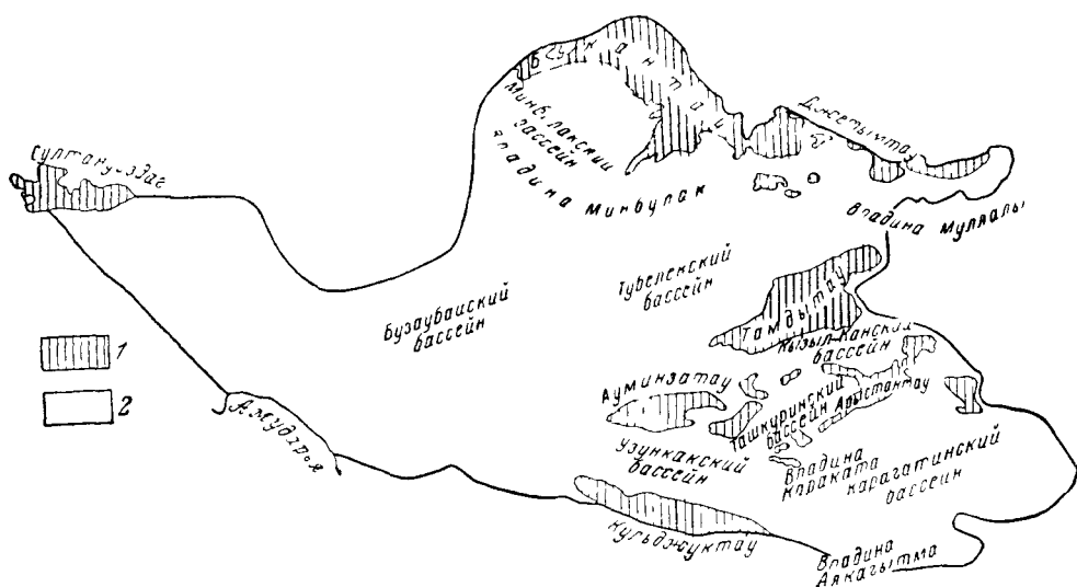
Рис. 26. Схема гидрогеологического районирования Центрально-Кызылкумской группы трещинных вод
