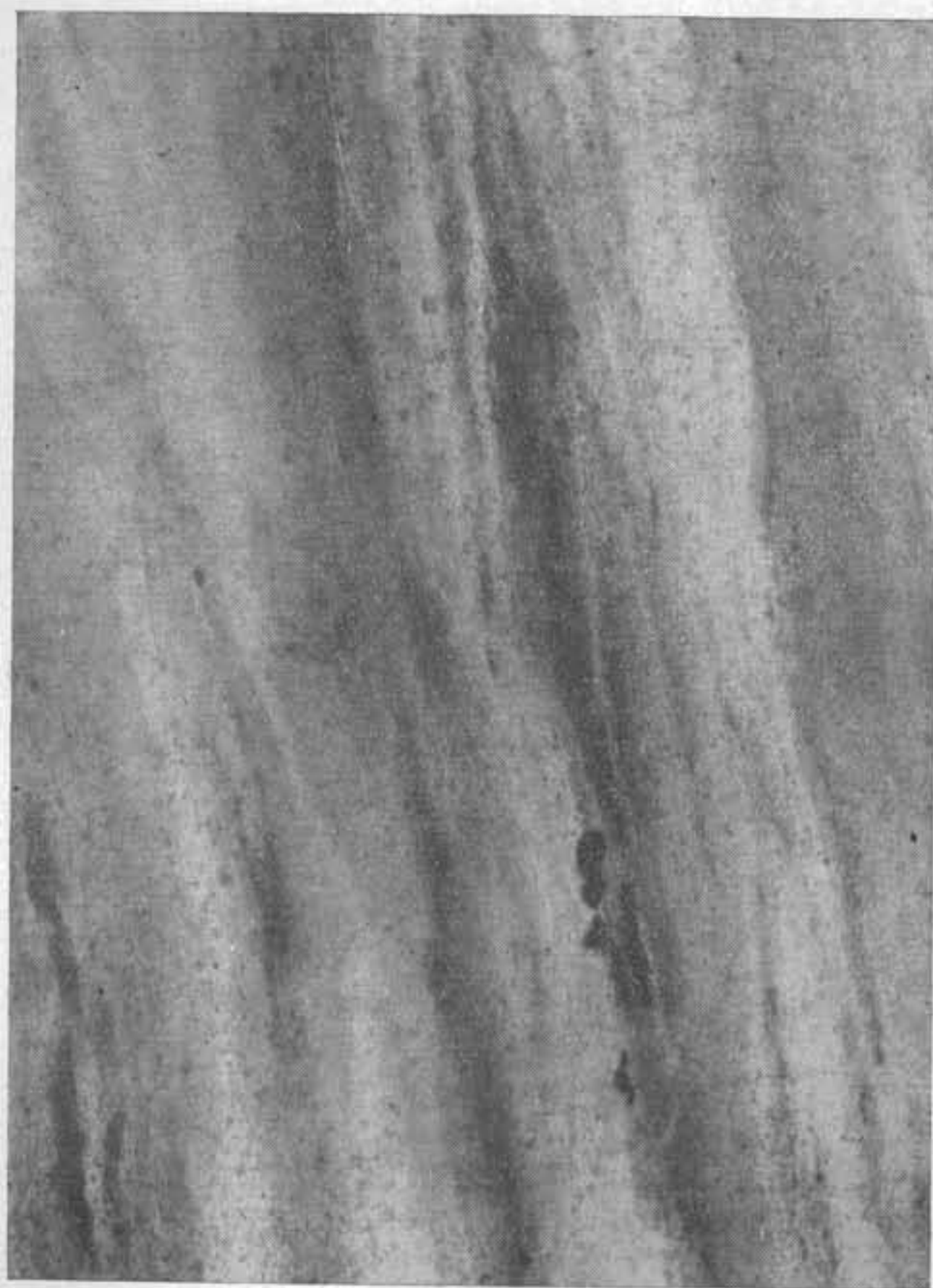
Фиг. 56. Слоистость повторно-жильного льда. Уменьш. в 1,8 раза (Фото Б. И. Втюрина)
