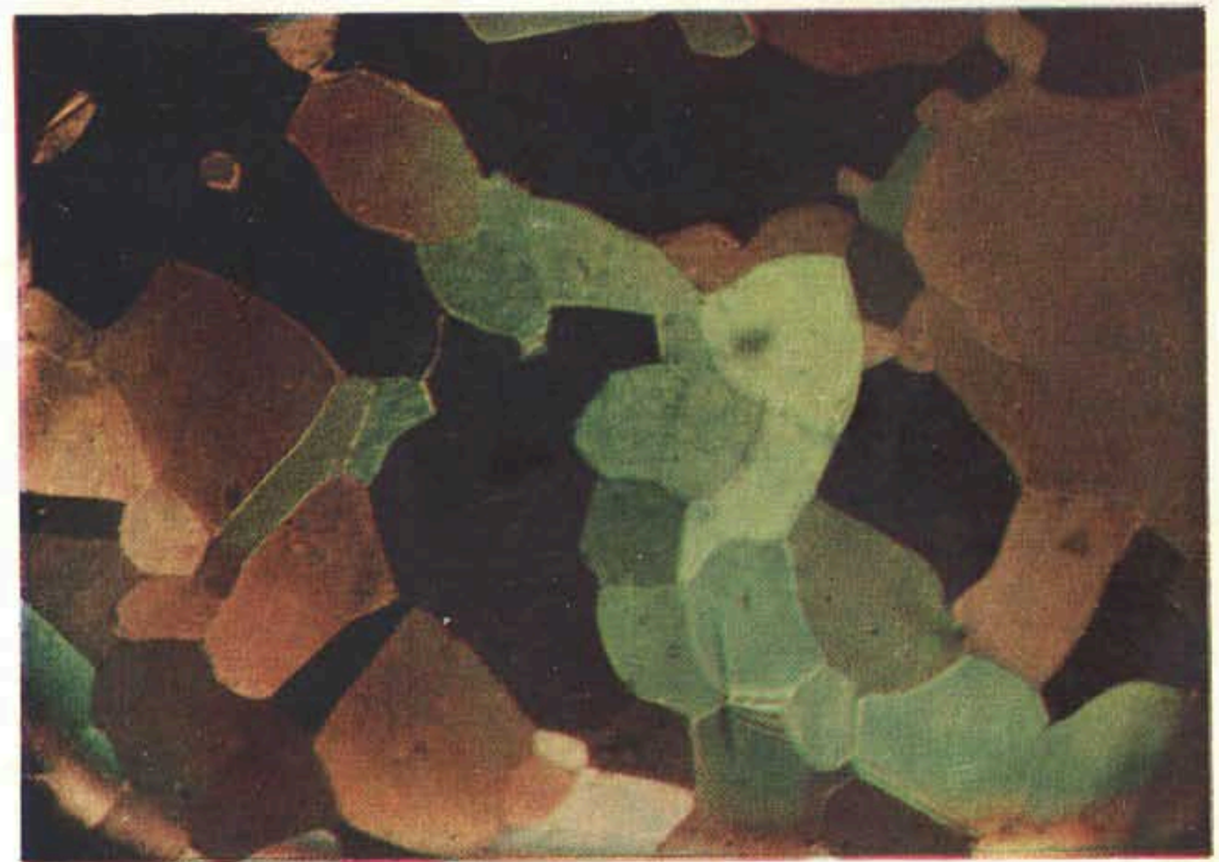
Фиг. 38. Призматически-зернистая структура конжеляционного льда (разрез в направлении роста) \times 6 . (Фото Б. А. Савельева)
