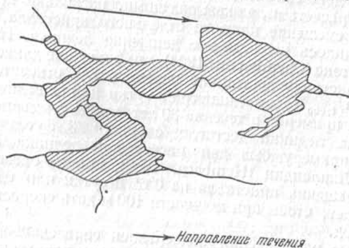
Фиг. 97. Вертикальное сечение кристалла ледникового льда, сформировавшегося в процессе течения.
