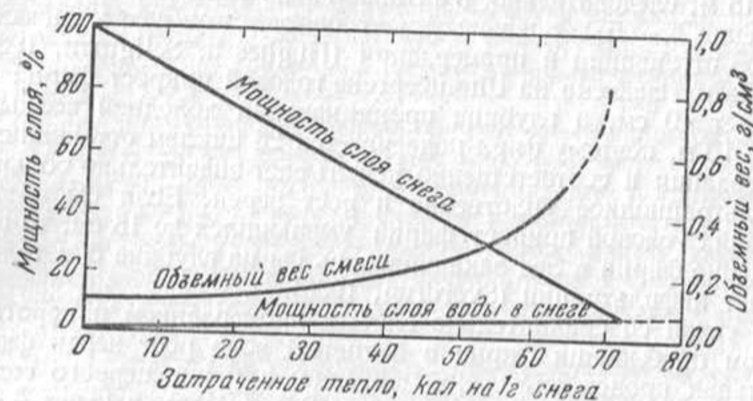
Фиг. 79. Диаграмма изменения фазового состава и объемного веса снега с начальным объемным весом 0,10 \text{ г/см}^3 по мере таяния без стока. (По В. Wilson, 1941)
