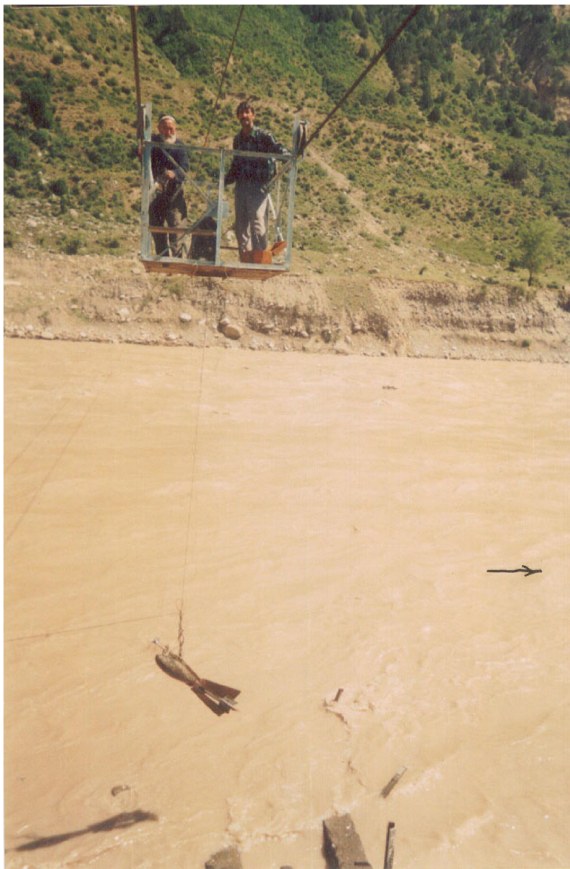
Фото 9. Измерение расхода воды на р.Вахш.
