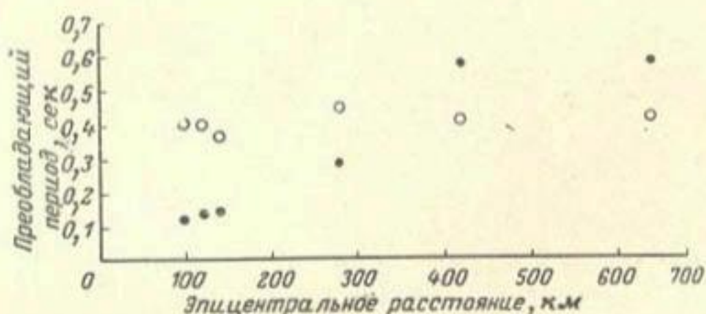
Рис. 47. Преобладающий период, измеренный на гребне и в основании плотины. О — гребень; ● — основание.
