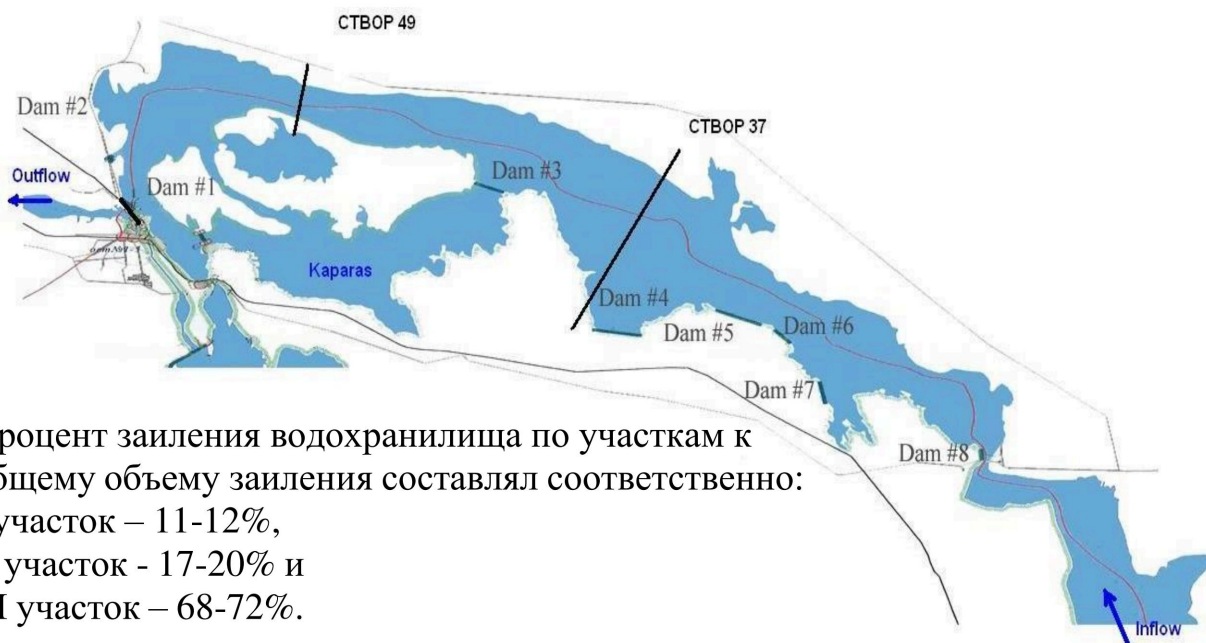
Рисунок 2.1 Распределение объема заиления по участкам чаши Руслового водохранилища
