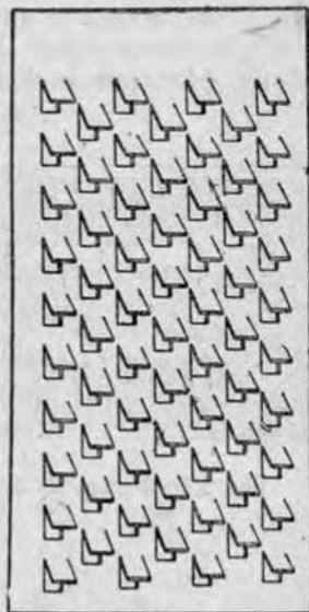
Рис. 229. Фильтр с перекрытыми щелями (по Гарде).
