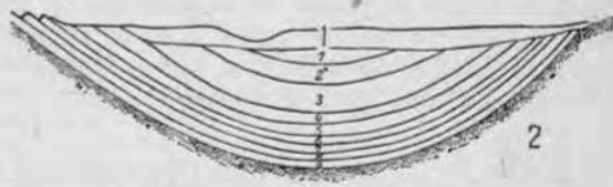
Рис. 30. Разрез артезианского бассейна в Вайоминге (по Найту).
