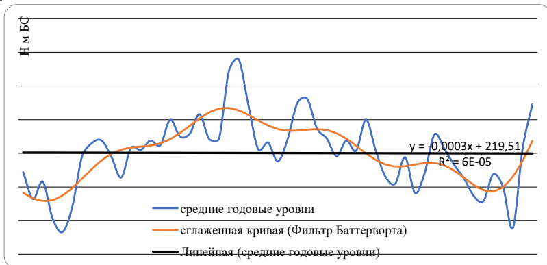
Рис. 3. Хронологический график хода уровней воды в СКВ. 37 Смолинского наблюдательного пункта подземных вод
