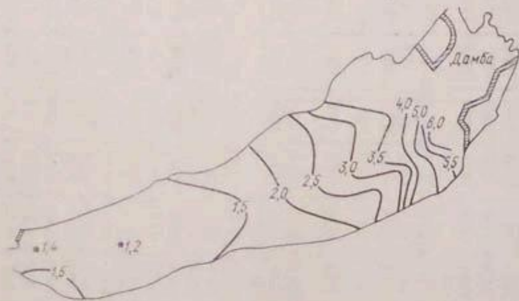
Рис. 5.2. Распределение температуры поверхности воды (°C) Кайраккумского водохранилища.
