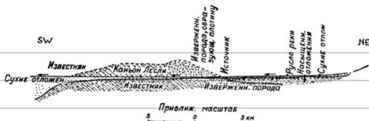
Рис. 90. Разрез, показывающий неглубокое залегание вод у вершины каньона Лесли в Свиссхельмских горах, в Аризоне, вызванное наклоненными пластами.
