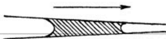
Рис. 36. Схематическое изображение воронкообразной капиллярной трубки, показывающее направление результирующего капиллярного притяжения.
