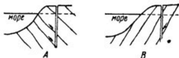
Рис. 104. Схематический разрез, показывающий значение падения трещин в отношении попадания морской воды в колодцы.
