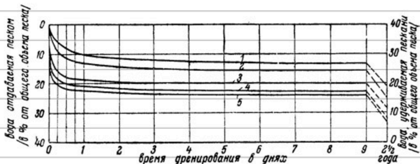
Рис. 20. Диаграмма, показывающая скорость водоотдачи в сортированных песках и количество воды, удержанной к концу двух с половиной лет при опытах Кинга. Понижение кривой в промежутке от 9 дней до 2½ лет представляет отчасти дренаж в течение этого периода, но главным образом разницу между пористостью и всей измеренной водой.
