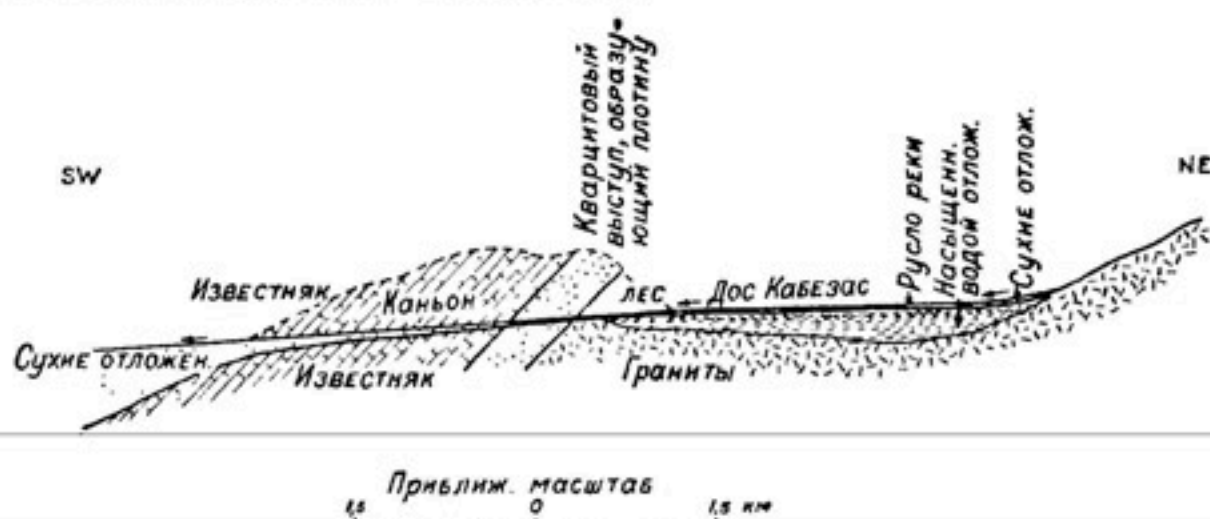
Рис. 87. Разрез, показывающий неглубокое залегание вод у Дос-Кабезаса в Аризоне, обусловленное устойчивым при выветривании наклонным пластом кварцита.
