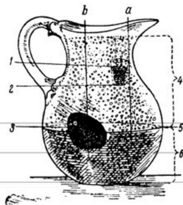
Рис. 14. Простой способ иллюстрации насыщенной зоны, водной поверхности, и подвешенного водного горизонта.
