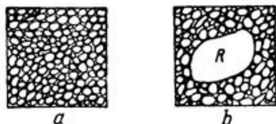
Рис. 5. Уменьшение пористости вследствие добавления крупного зерна ( R ) к агрегату мелких зерен.
