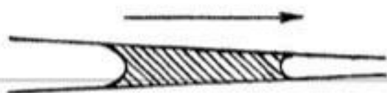
Рис. 36. Схематическое изображение воронкообразной капиллярной трубки, показывающее направление результирующего капиллярного притяжения.
