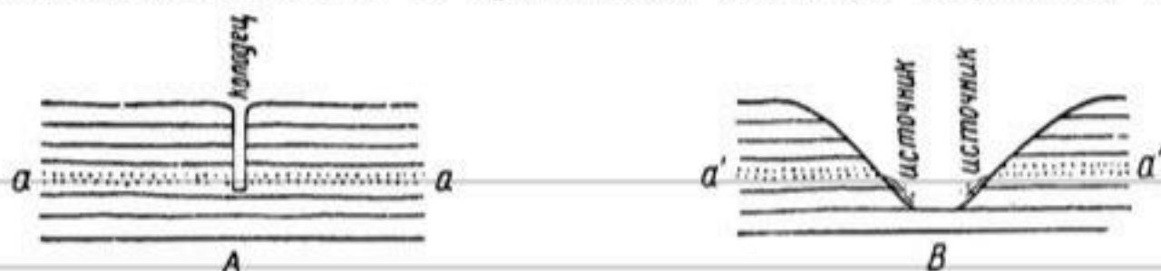
Рис. 124. Схематический разрез, показывающий, как в долине, углубленной до водного горизонта или ниже его, создаются условия, подобные условиям в колодце.
