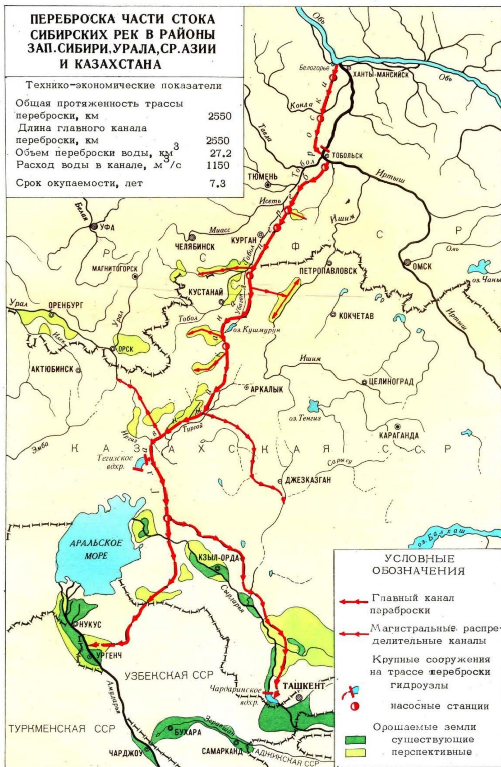
Рис. 1. Схема переброски части стока рек Иртыш и Обь (ТЭО 1978 г.).
