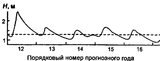
Рис. 3.4. Фрагмент прогнозного ряда внутригодового режима уровня грунтовых вод (скв. 30)
