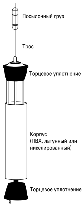
Рисунок 1.7.5. Пробоотборник Кеммерера
