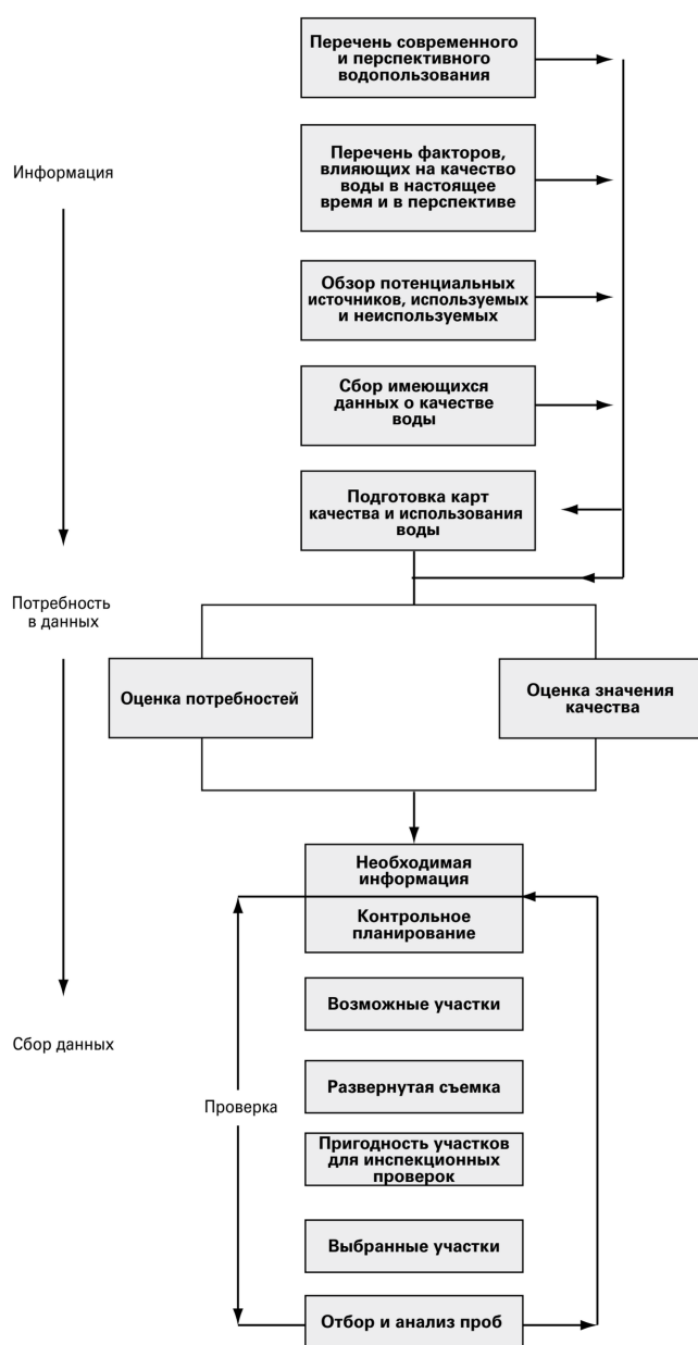
Рисунок I.7.1. Схема для выбора участков отбора проб на качество воды
