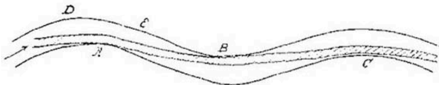
Рис. 33. Отложение наносов при лабораторных опытах.
