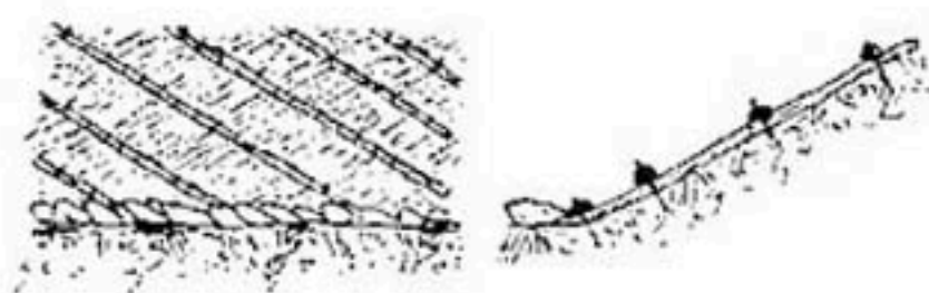
Рис. 156. Хворостяная выстилка наклонными рядами.
