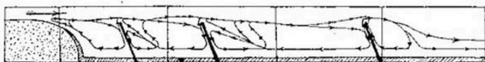
Рис. 164. Последняя полузапруда отставлена на двойное расстояние.
