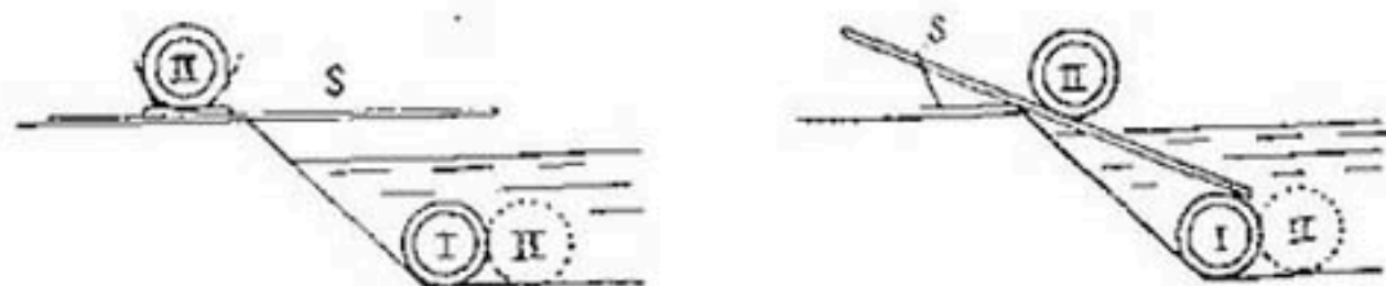
Рис. 101. Вязка и спуск двух длинных тяжелых фашин.
