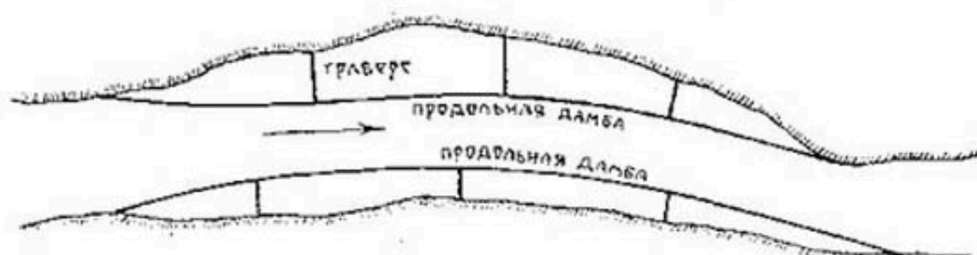
Рис. 45. Выправление русла парными (двухсторонними) дамбами.
