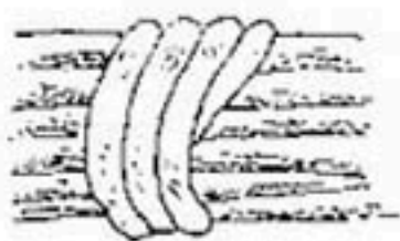
Рис. 91. Обвязка прутяного каната вицей.
