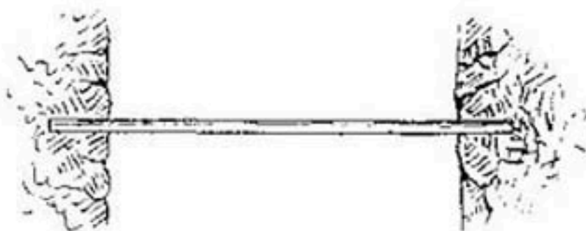
Рис. 262. Заделка жердей (поперечин) в откосы.
