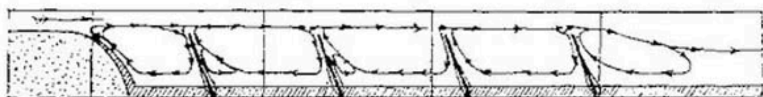
Рис. 163. Полузапруды расставлены на равных расстояниях.
