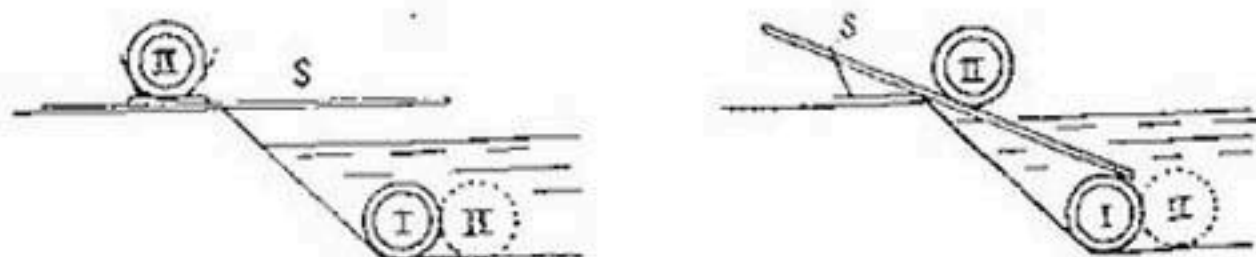
Рис. 101. Вязка и спуск двух длинных тяжелых фашин.
