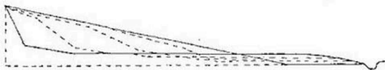
Рис. 243. Образование и развитие ложбины горного потока (продольный разрез).
