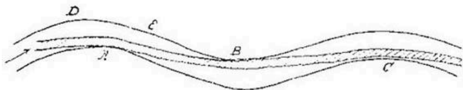
Рис. 33. Отложение наносов при лабораторных опытах.
