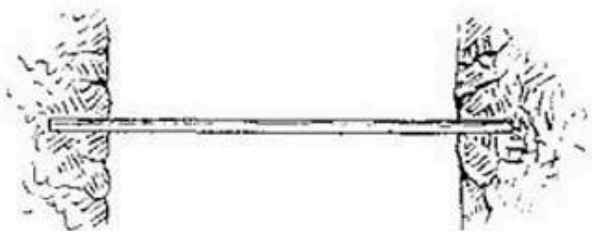
Рис. 262. Заделка жердей (поперечин) в откосы.
