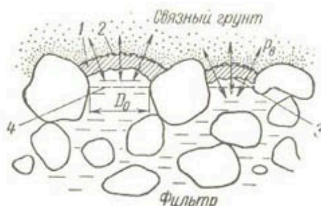
Рис. 15. Схема размокания связного грунта на контакте с фильтром
