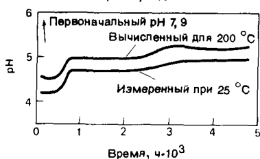
Р и с. 10.5. Изменение состава морской воды при ее нагревании с базальтом при температуре 200°С и давлении 500 бар (по Бишоффу и Диксону [30]).
